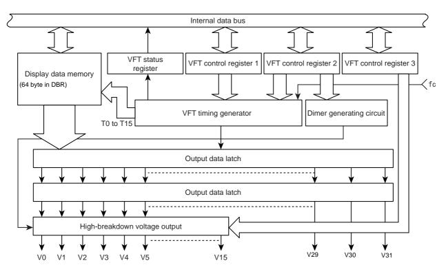
Figure 17-1 Vacuum Fluorescent Display (VFT) Circuit
