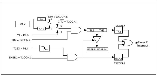
Figure 14. 16-Bit Capture Mode
