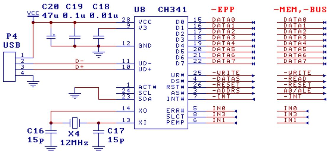
在设计印刷电路板 PCB 时, 需要注意: 退耦电容 C18 和 C19 尽量靠近 CH341 的相连引脚; 使 D+
