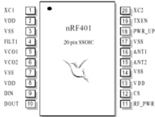
图 2 nRF401 管脚定义图
