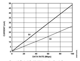
Figure 15. Typical ADuM2402  $V_{\rm DD1}$  or  $V_{\rm DD2}$  Supply Current vs. Data Rate for 5 V and 3 V Operation
