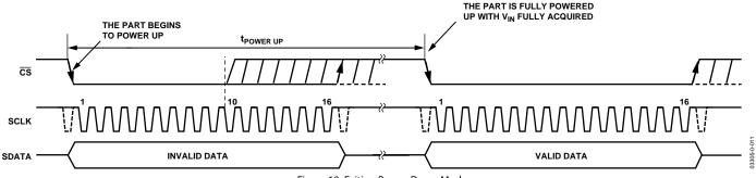
Figure 18. Exiting Power-Down Mode
