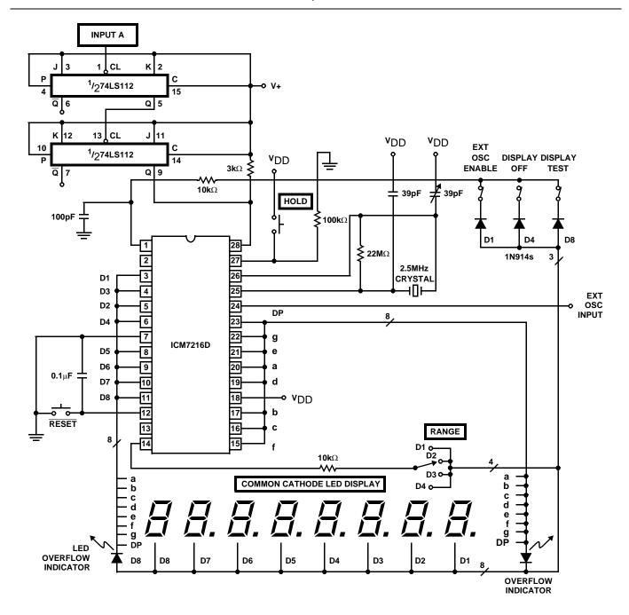
FIGURE 16. 40MHz FREQUENCY COUNTER
