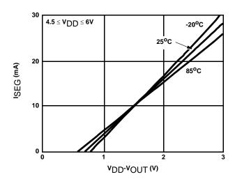
FIGURE 3. TYPICAL I<sub>SEG</sub> vs  $V_{DD}$ - $V_{OUT}$
