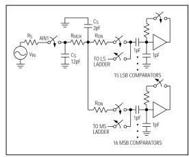
Figure 9a. Equivalent Input Circuit
