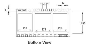
**DIMENSIONS** in 26 Pin DFN (mm) SYMBOL MIN NOM MAX 0.800 0.850 0.900 Α1 0.000 0.050 0.203 АЗ 0.178 0.228 0.17 0.27 b D 6.95 7.00 7.05 D2 2.00 2.05 2.10 D3 1.78 1.83 1.88 0.45 0.55 е 0.50 3.95 4.00 4.05 E2 2.730 2.780 2.830 0.350 0.400 0.450
