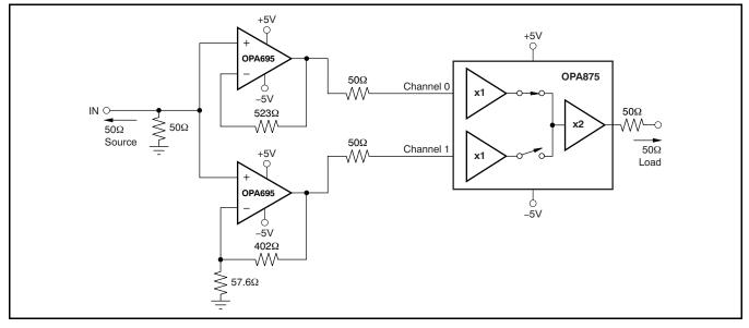
Figure 25. 1-Bit, High-Speed PGA
