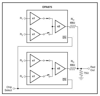
Figure 29. 4-Input RGB Router
