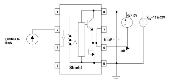
Figure 17. IOH Test Circuit
