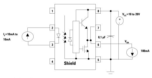
Figure 19. VOH Test Circuit
