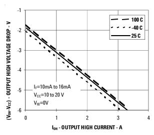
Figure 3. V<sub>OH</sub> Vs I<sub>OH</sub>
