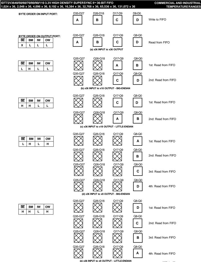
Figure 4. Bus-Matching Byte Arrangement
