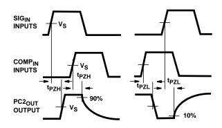
FIGURE 9. THREE STATE ENABLE AND DISABLE TIMES FOR  $\mathsf{PC2}_\mathsf{OUT}$
