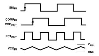
FIGURE 3. TYPICAL WAVEFORMS FOR PLL USING PHASE COMPARATOR 1, LOOP LOCKED AT  $f_{\rm o}$
