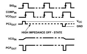
FIGURE 5. TYPICAL WAVEFORMS FOR PLL USING PHASE COMPARATOR 2, LOOP LOCKED AT  $\mathbf{f}_{\mathbf{0}}$
