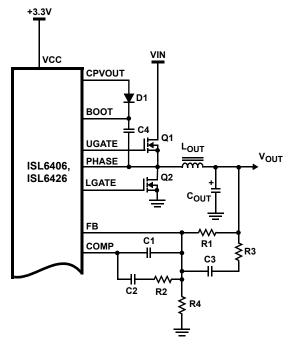
**FIGURE 4. OUTPUT VOLTAGE SELECTION**
