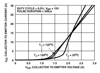
FIGURE 6. COLLECTOR TO EMITTER ON-STATE VOLTAGE
