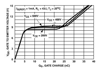
FIGURE 14. GATE CHARGE WAVEFORMS
