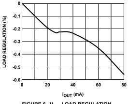
FIGURE 6. V<sub>ON</sub> LOAD REGULATION
