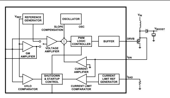
FIGURE 25. FUNCTION DIAGRAM OF THE BOOST CONTROLLER
