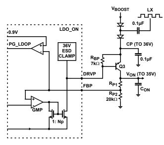
FIGURE 27. VON FUNCTIONAL BLOCK DIAGRAM
