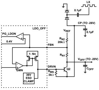
FIGURE 28. VOFF FUNCTIONAL BLOCK DIAGRAM
