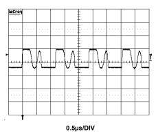
FIGURE 17. LX WAVEFORM-DISCONTINUOUS MODE
