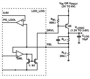
FIGURE 29. VLOGIC FUNCTIONAL BLOCK DIAGRAM
