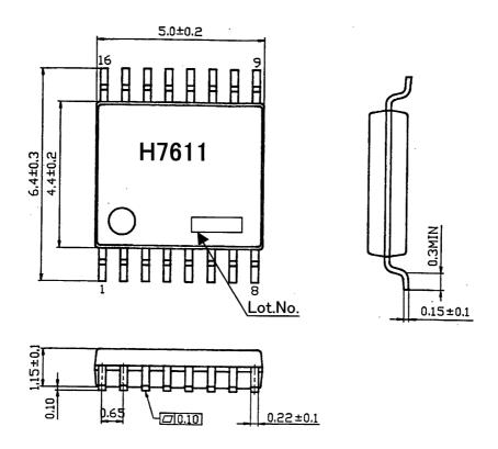
SSOP-B16 (Unit: mm)
