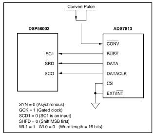
FIGURE 17. DSP56002 Interface to the ADS7813.
