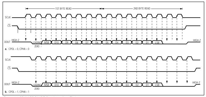
Figure 14. SPI/MICROWIRE Serial-Interface Timing
