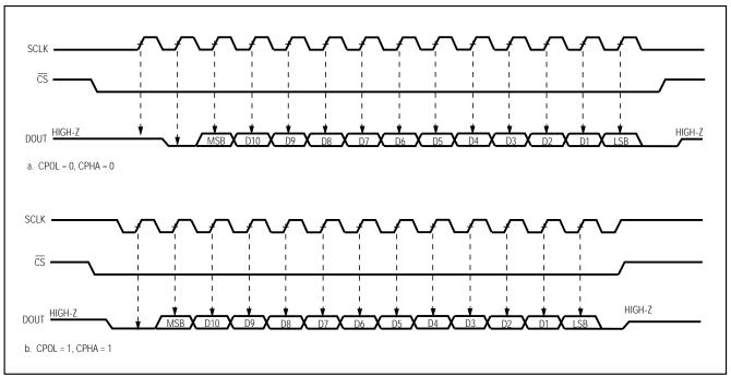
Figure 15. QSPI Serial-Interface Timing
