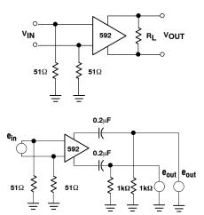
Figure 24. Test Circuits
