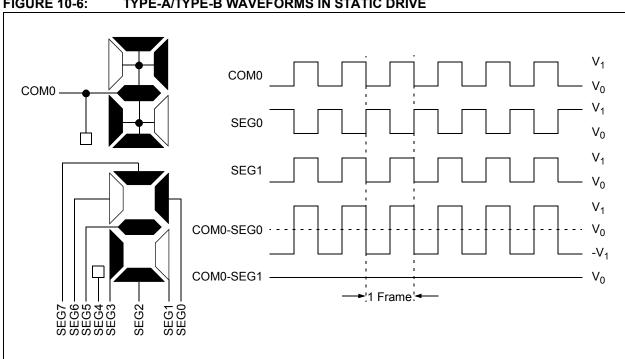
**FIGURE 10-6:** TYPE-A/TYPE-B WAVEFORMS IN STATIC DRIVE
