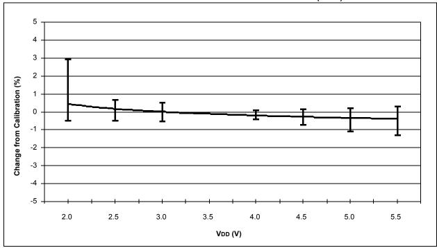
FIGURE 20-39: TYPICAL HFINTOSC FREQUENCY CHANGE OVER DEVICE VDD (85°C)
