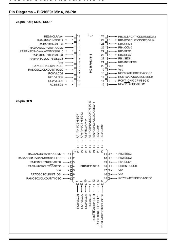
TABLE 2: PIC16F913/916 28-PIN (PDIP, SOIC, SSOP) SUMMARY
