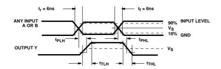
FIGURE 1. PROPAGATION DELAY AMD TRANSITION TIMES
