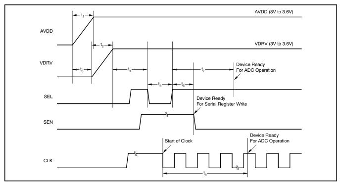
NOTE:  $10\mu s < t_1 < 50m s$ ;  $10\mu s < t_2 < 50m s$ ;  $-10m s < t_3 < 10m s$ ;  $t_4 > 10m s$ ;  $t_5 > 100n s$ ;  $t_6 > 100n s$ ;  $t_7 > 10m s$ ; and  $t_8 > 100\mu s$ .
