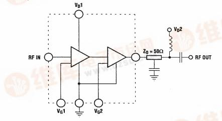
2-Stage AMPS **Power Amplifier** IC
