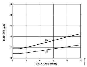
Figure 15. Typical ADuM1412  $V_{\rm DD1}$  or  $V_{\rm DD2}$  Supply Current vs. Data Rate for 5 V and 3 V Operation
