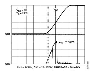
Figure 27. Power-On Reset to 0 V
