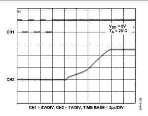
Figure 28. Exiting Power-Down Mode
