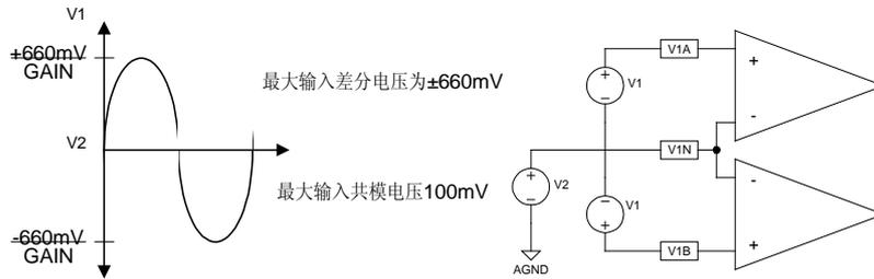
电流通道的典型连接电路下图，其中，第一种是用两个 CT（电流互感器）分别采样火线和零线的电流，Rb 作为负载电阻用来产生差分信号±660mV/gain，第二种是用 PT（电压互感器）和电阻分压网络提供电压信号。
