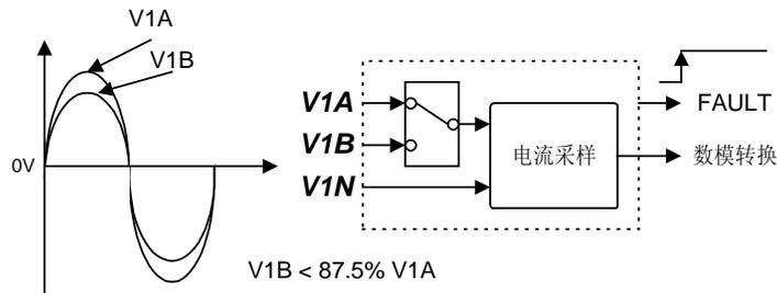
如果开始时 V1A 作为计量，且 V1B 不断增加，当 V1B 大于 114% V1A 时，FAULT 指示会变亮，此时将会按照 V1B 进行计量，并且只有当 V1A 大于 114% V1B 时才会重新按照 V1A 计量，但是只要 V1A 与 V1B 的差值小于 12.5% V1B，FAULT 指示不亮。
