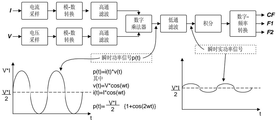
在通过对电流电压信号高精度采样及模数转换后，电流电压信号通过数字乘法器得到瞬态功率信号  $p(t)$ 。让  $p(t)$  通过一个截至频率很低（如 1Hz）的取直低通滤波器，把即时实功率信号取出来。然后对该实功率信号对时间进行积分，得到能量的信息。如果选择积分时间十分的短，可以认为得到的是即时能量消耗的信息，也可以认为是即时功率消耗的信息，因为前后两者成正比关系。如果选择的较长的积分时间，得到的是平均的能量消耗的信息，同样也可以认为是平均功率消耗的信息。
