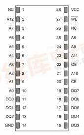
28-PIN ENCAPSULATED PACKAGE 720 MIL EXTENDED
