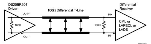
Typical DS25BR204 Output DC-Coupled Interface to an LVDS, CML or LVPECL Receiver
