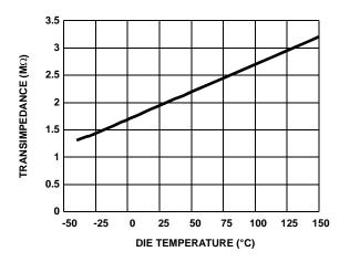
FIGURE 25. TRANSIMPEDANCE vs TEMPERATURE
