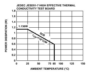
FIGURE 26. PACKAGE POWER DISSIPATION vs AMBIENT TEMPERATURE
