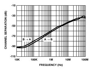
FIGURE 13. CHANNEL SEPARATION vs FREQUENCY
