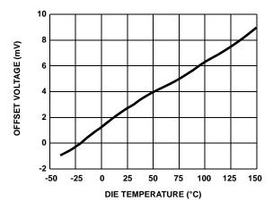
FIGURE 23. OFFSET VOLTAGE vs TEMPERATURE
