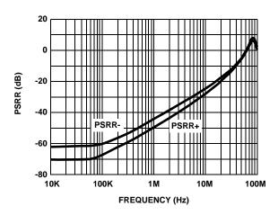
FIGURE 15. PSRR vs FREQUENCY
