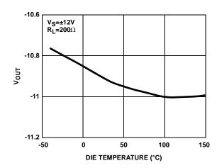
FIGURE 24. OUTPUT VOLTAGE vs TEMPERATURE
