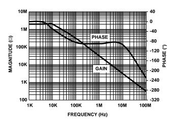
FIGURE 17. TRANSIMPEDANCE (ROL) vs FREQUENCY
