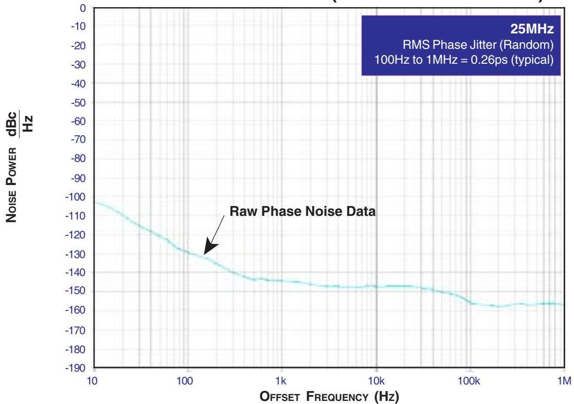
**TYPICAL PHASE NOISE AT 25MHz (3.3V CORE/ 3.3V OUTPUT)**
