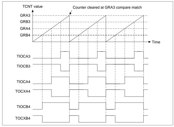
Figure 10.32 Reset-Synchronized PWM Mode Operation Example 1
