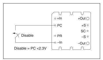
**Figure 2** — Module enable/disable.
