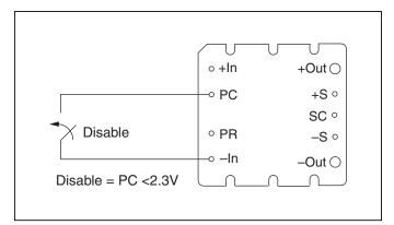
Figure 2 — Module enable/disable.
