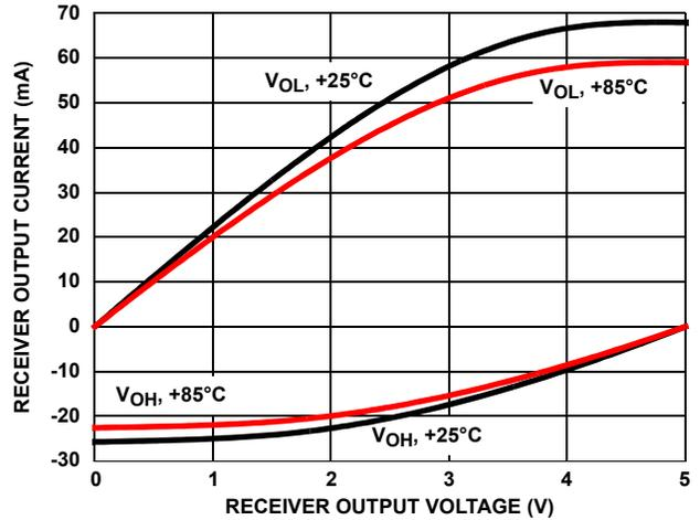
FIGURE 13. RECEIVER OUTPUT CURRENT vs RECEIVER OUTPUT VOLTAGE
