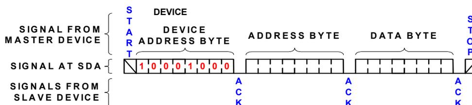
FIGURE 11. BYTE WRITE SEQUENCE
