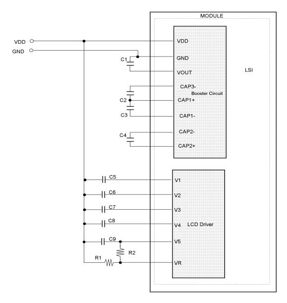
$\begin{array}{ll} \text{C1$\sim$C4} : 1.0 \mu\text{F}/16\text{V} \\ \text{C5$\sim$C8} : 0.68 \mu\text{F}/16\text{V} \\ \text{R1} : & 270 \text{K}\Omega \pm 0.2\% \\ \text{R2} : & 1.1 \text{M}\Omega \pm 0.2\% \\ \end{array}$
