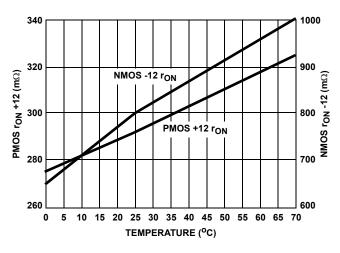
FIGURE 1. r<sub>ON</sub> vs TEMPERATURE
