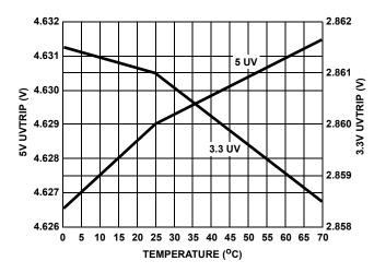
FIGURE 2. UV TRIP vs TEMPERATURE
