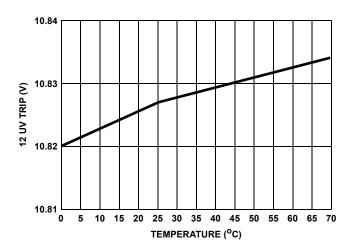
FIGURE 3. 12 UV TRIP vs TEMPERATURE
