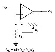
FIGURE 15. NONINVERTING AMPLIFIER
