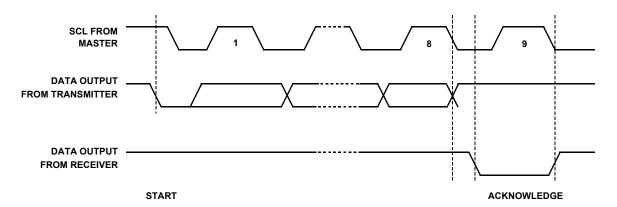
FIGURE 11. ACKNOWLEDGE RESPONSE FROM RECEIVER
