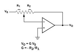
FIGURE 21. INVERTING AMPLIFIER
