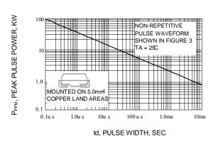
Fig. 1-PEAK PULSE POWER RATING CURVE
