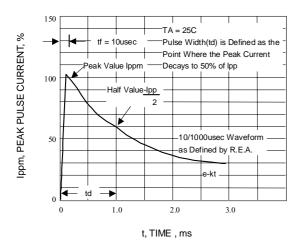
Fig. 3-PULSE WAVEFORM
