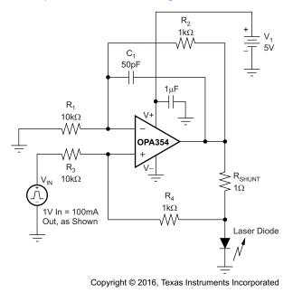
Figure 30. Laser Diode Driver
