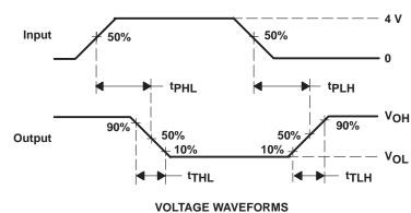
for V<sub>IT</sub>, V<sub>OH</sub>, and V<sub>OL</sub>
