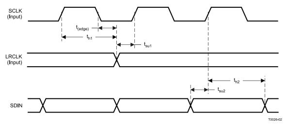
Figure 1. Slave-Mode Serial-Data Interface Timing
