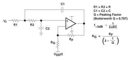
Figure 27. 2-Pole Low-Pass Sallen-Key Filter
