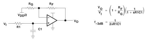
Figure 26. Single-Pole Low-Pass Filter
