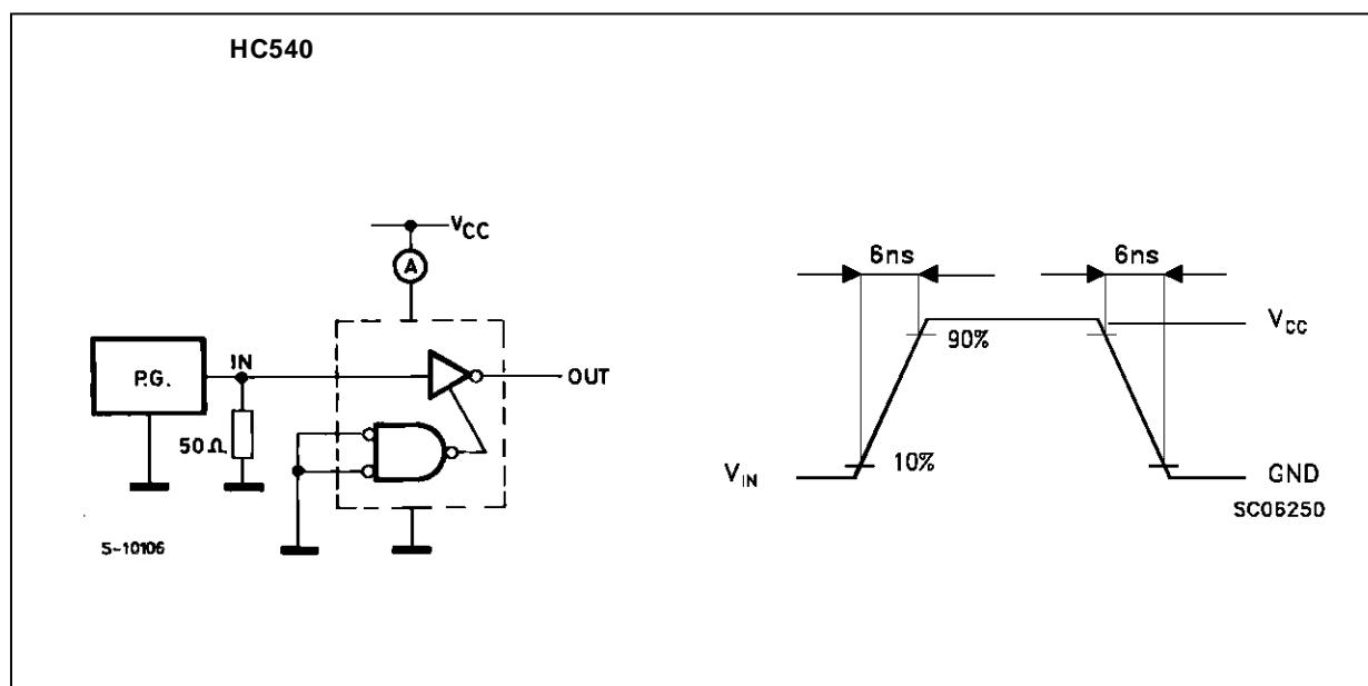
**SWITCHING CHARACTERISTICS TEST CIRCUIT**
