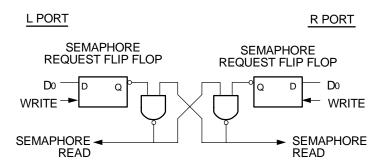
Figure 4. IDT70T35/34L (IDT70T25/24L) Semaphore Logic
