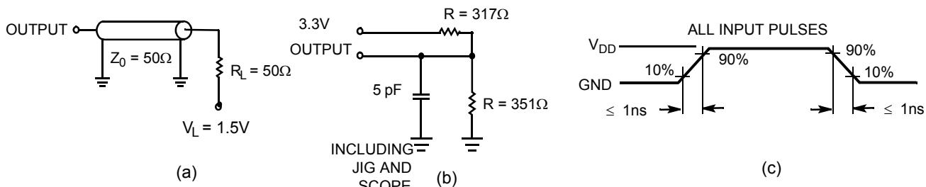
**2.5V I/O Test Load**
