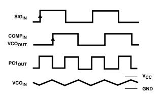
FIGURE 3. TYPICAL WAVEFORMS FOR PLL USING PHASE COMPARATOR 1, LOOP LOCKED AT  $\mathbf{f}_{o}$
