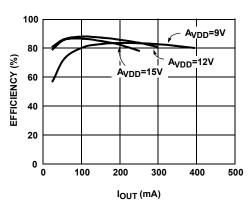
FIGURE 3.  $V_{BOOST}$  EFFICIENCY AT  $V_{IN}$  = 3V (P MODE)
