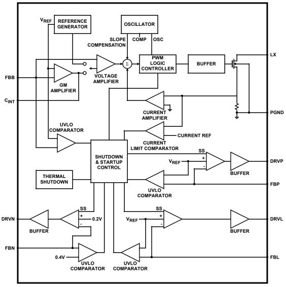
FIGURE 25. BLOCK DIAGRAM
