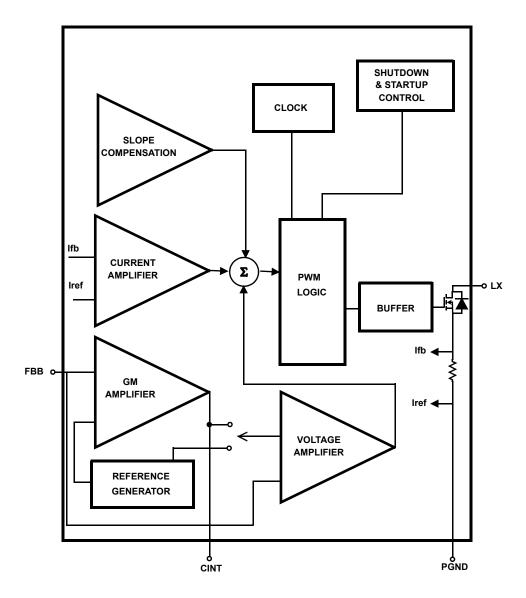
FIGURE 26. BLOCK DIAGRAM OF THE BOOST REGULATOR
