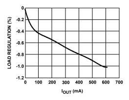
FIGURE 13.  $V_{LOGIC}$  LOAD REGULATION
