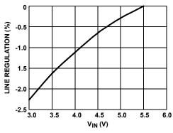
FIGURE 10.  $V_{\mbox{\footnotesize{BOOST}}}$  LINE REGULATION (P MODE)
