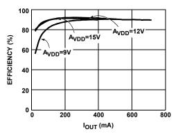
FIGURE 2.  $V_{BOOST}$  EFFICIENCY AT  $V_{IN}$  = 5V (PI MODE)
