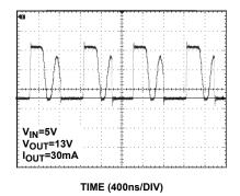
FIGURE 21. LX WAVEFORM - DISCONTINUOUS MODE
