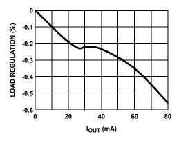
FIGURE 11.  $V_{ON}$  LOAD REGULATION
