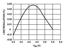
FIGURE 9.  $V_{\mbox{\footnotesize{BOOST}}}$  LINE REGULATION (PI MODE)
