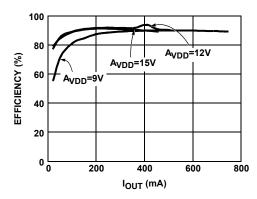
FIGURE 4. V<sub>BOOST</sub> EFFICIENCY AT V<sub>IN</sub> = 5V (P MODE)
