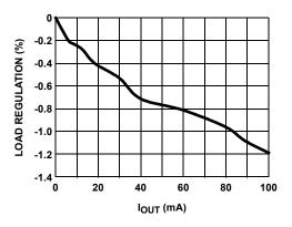
FIGURE 12. V<sub>OFF</sub> LOAD REGULATION
