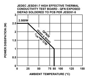
FIGURE 24. PACKAGE POWER DISSIPATION vs AMBIENT TEMPERATURE
