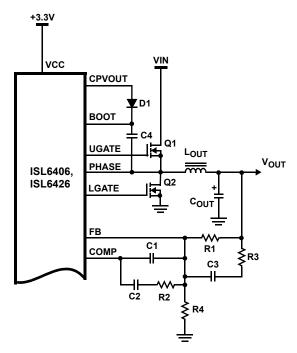
FIGURE 4. OUTPUT VOLTAGE SELECTION
